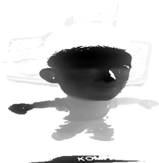
像素坐标是点的X和Y坐标的表示，而像素的灰度值是点的Z坐标的表示。
